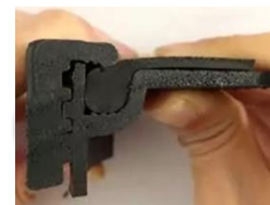
2-Estructura de la válvula de retención
